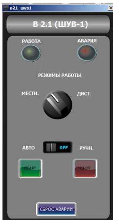
В появившемся модальном окне В2.1, В2.2 представлены органы управления и отображения информации о состоянии воздуходувок приемного резервуара и минерализатора осадка В2.1, В2.2.
