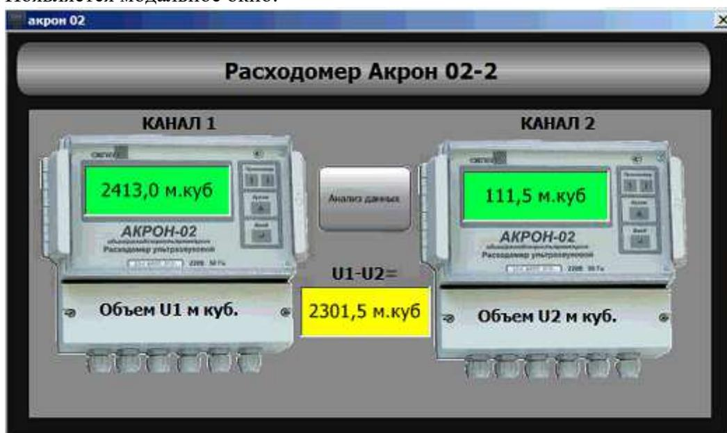
На дисплеях отображаются показания объемов по первому и второму каналам и значение разности этих объемов.
