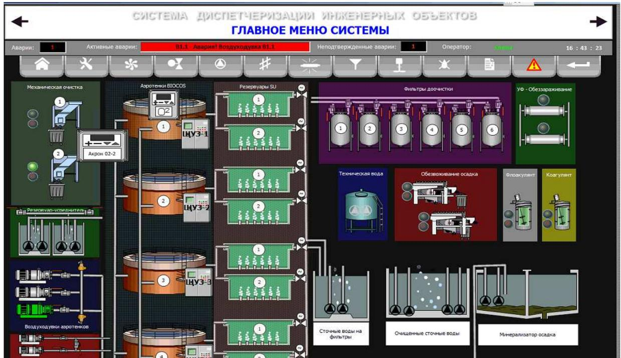
Главное меню системы дает представление о размещении основных систем на объекте, отображает отдельные параметры (работает, не работает, в аварии) систем и позволяет быстро перейти к требуемой странице с помощью соответствующих кнопок.
