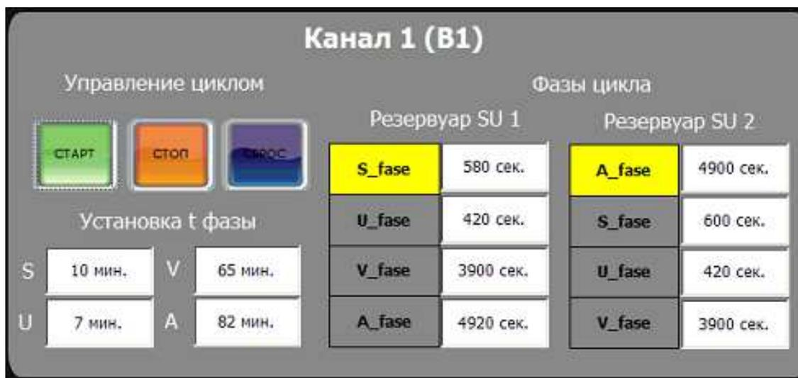
Запуск цикла осуществляется нажатием на кнопку «СТАРТ» панели управления. При необходимости прерывания цикла с последующим возобновлением (пауза) необходимо нажать «СТОП». В этом случае, повторное нажатие кнопки «СТАРТ» приведет к возобновлению цикла с того временного момента на котором он был прерван. Нажатие кнопки «СБРОС» приведет к перезапуску цикла с начального момента времени.
